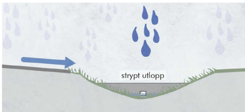
Figur 14. Principskiss för svackdike med strypt utlopp (Illustration: Sweco)
