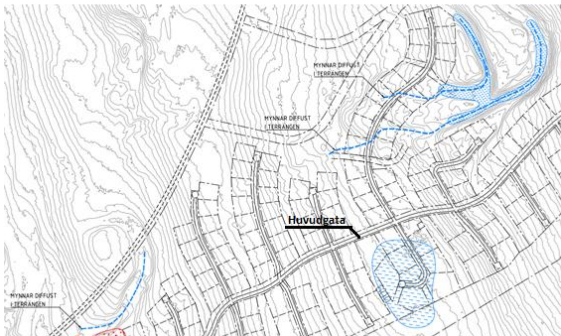
Figur 2. Områden som riskerar att bli vattensjuka vid snösmältning med befintliga förutsättningar.
