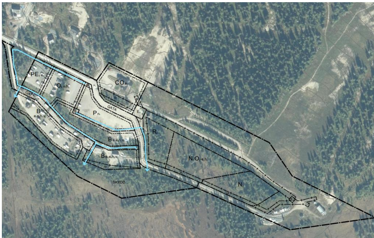
Figur 4 Schematisk bild över tillkommande dagvattenstråk inom planområdet
