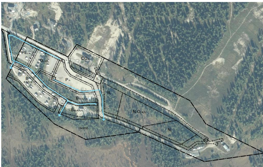
Schematisk bild över dagvattenstråk som kommer att anläggas eller förstärkas vid ett genomförande av planen.
